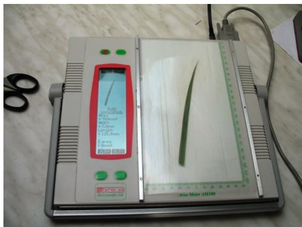
Obr. 54. Měření velikosti listové plochy přístrojem AM 300 u Festuca arundinacea
